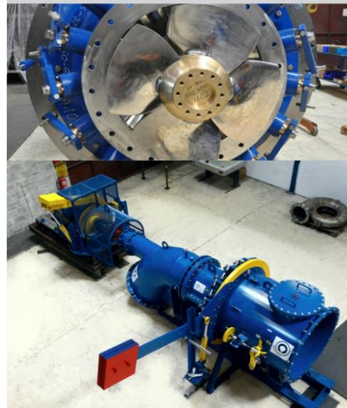
Турбины Каплана подходят для низкого напора и большого потока с достигаемой эффективностью более 92%. Мы производим вертикальные и горизонтальные турбины Каплана. Фиксированное, одиночное или двойное регулирование для лучшей гибкости. Мы предлагаем проверенные технологии.
