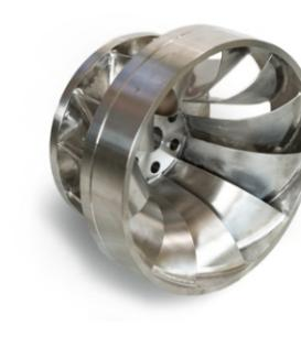
Мы проектируем и поставляем высокого качества литья головки турбин Фрэнсиса из материала 1.4317. Головки финишно обработаны, отполированы и сбалансированы.
